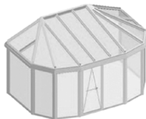
Pulldach mit abgewalmten Dachflächen
