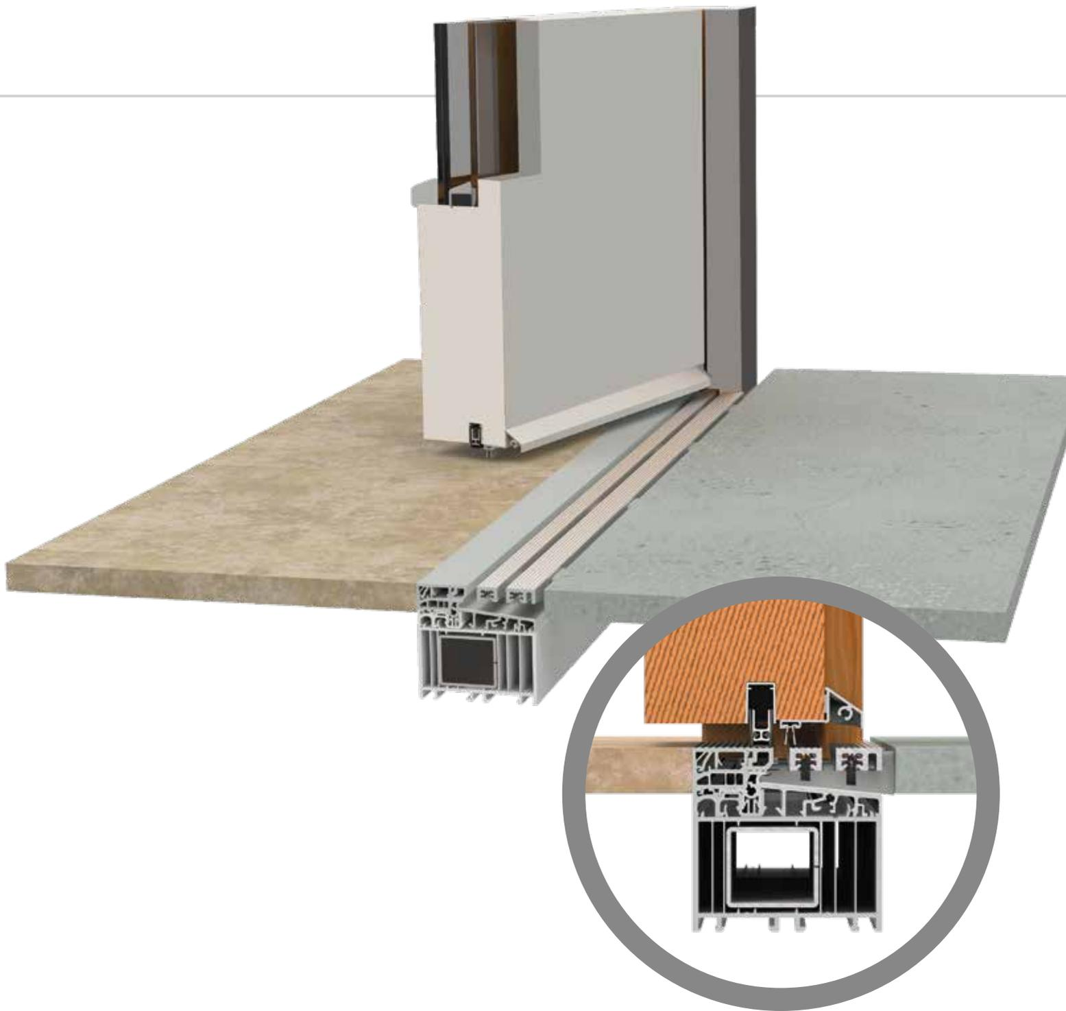
Bei Fenstertüren können in einem speziell konstruierten Bereich der Schwelle Schließplatten bündig eingebaut werden. Diese Zusatzverriegelung ermöglicht es, Standard-Drehkipp-Beschläge auch bei der **barrierefreien Lösung** zu verwenden.
